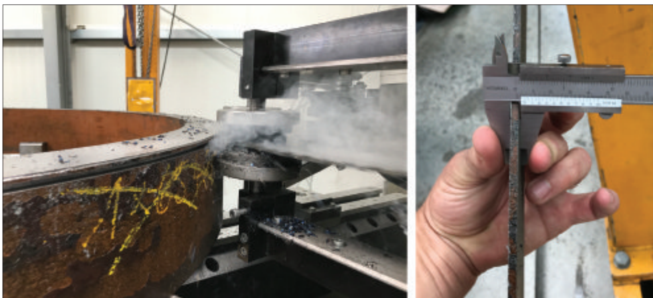
图5 新型机械可切割高度小至4.5 mm的环件
