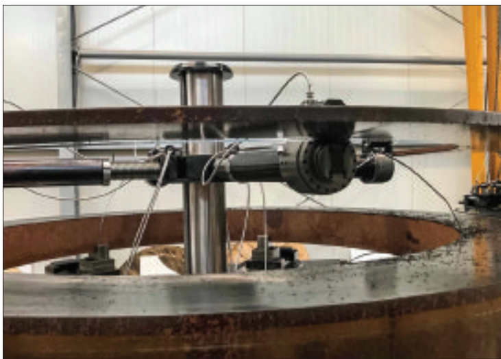
图3 在完成切割之后夹持臂立即提起环件
