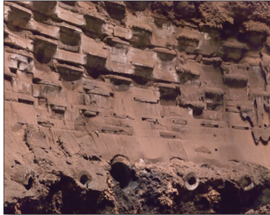
图 12 2009年产铁51 Mt之后的炉腹状况
